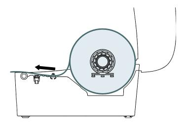
(7) 請使用 "Diagnostic Tool 工具程式"依紙張類別設定適當的感應器類型並校正標籤感應器。(開啓 "Diagnostic tool"→ 選取 "Printer Configuration" 頁面 → 按下 "Calibrate Sensor" 鍵 ) 若您需要更詳盡的資訊,請參見 Diagnostic utility quick start guide
