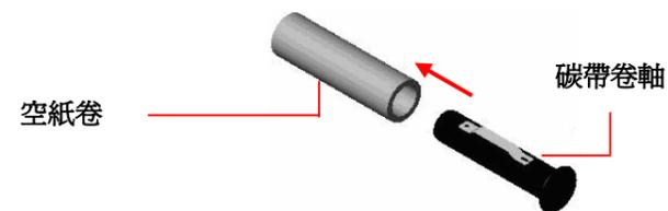
3. 將碳帶回卷紙軸安置在前碳帶制動器上。
