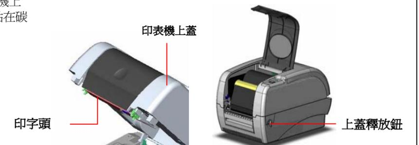
7. 以順時針方向捲動碳帶回卷軸，捲緊碳帶，使碳帶上沒有任何皺折。
