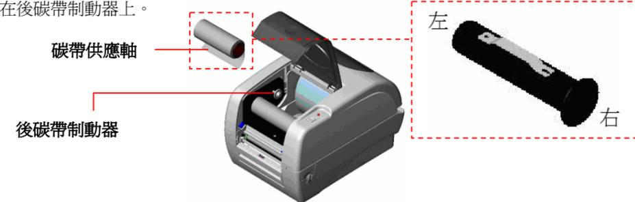
6. 雙手向前推上蓋釋放鈕以打開印表機上蓋。將碳帶繞過印字頭，平整的黏貼在碳帶回卷軸上。
