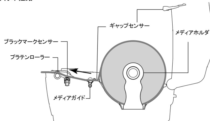
(7) 「Menu(メニュー)」ボタンまたは「Diagnostic Tool(診断ツール)」を使ってメディアセンサーの種類をセットし、選択したセンサーを校正します。「Diagnostic tool(診断ツール)」をスタートし、→「Printer Configuration(プリンタ構成)」タブを選択して、→「Calibrate Sensor(センサーの校正)」ボタンをクリックします) 詳細については、診断ユーティリティクイックスタートガイドを参照してください。
