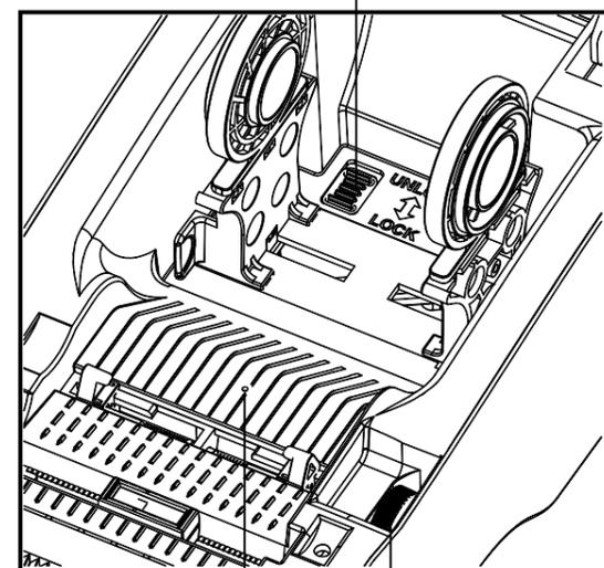
Датчик зазора (передатчик)
