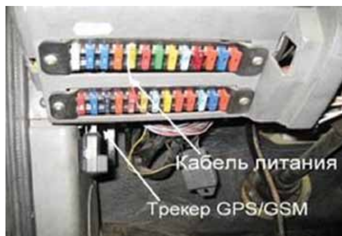
Рис.3. Пример размещения УР под приборной панелью при скрытой установке
