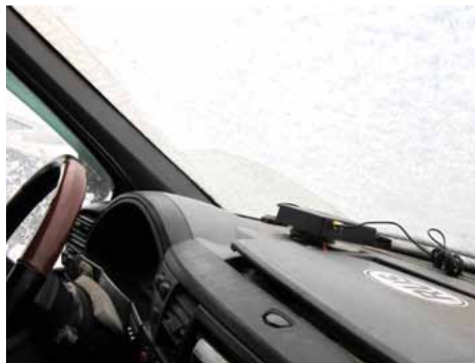
Рис.2. Пример расположения прибора УР над приборной панелью
