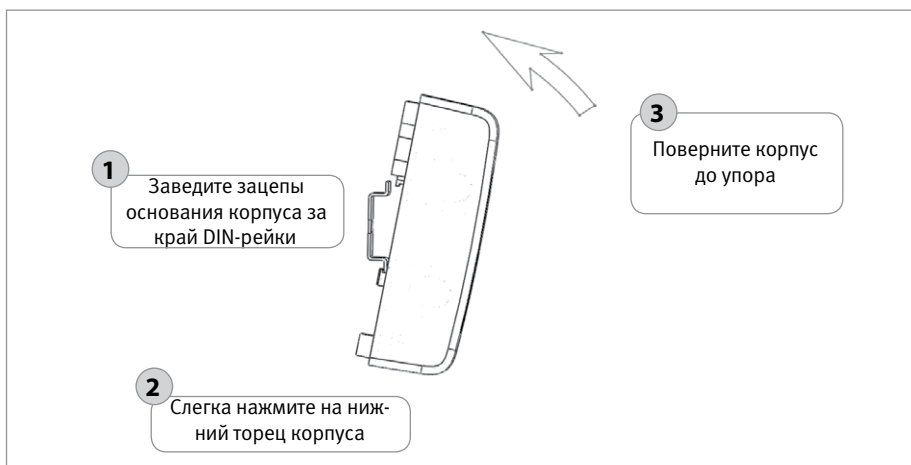
Рисунок 23. Порядок установки прибора на DIN-рейку
