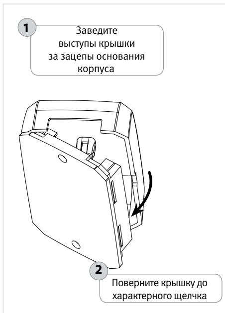
Рисунок 25. Снятие крышки прибора
