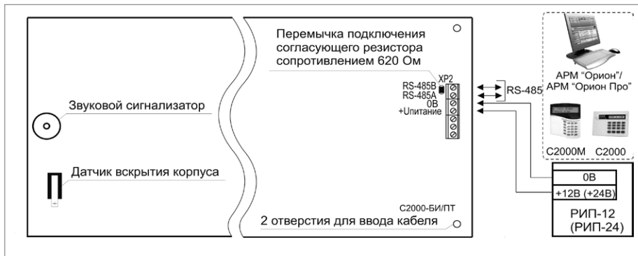
Рисунок 1. Схема внешних соединений блока «C2000-БИ SMD»
