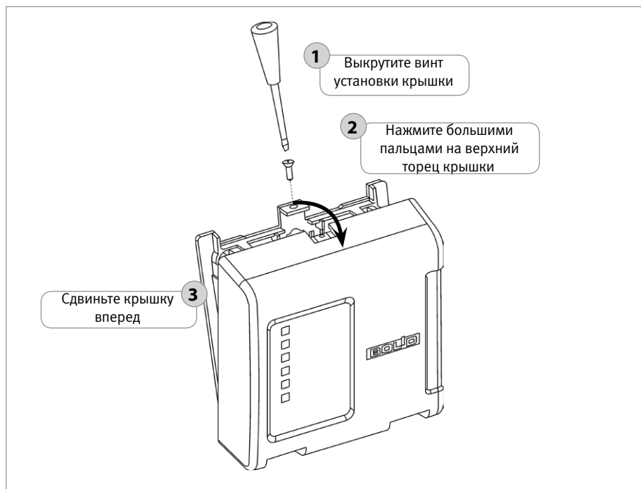
Рисунок 33. Снятие крышки изделия
