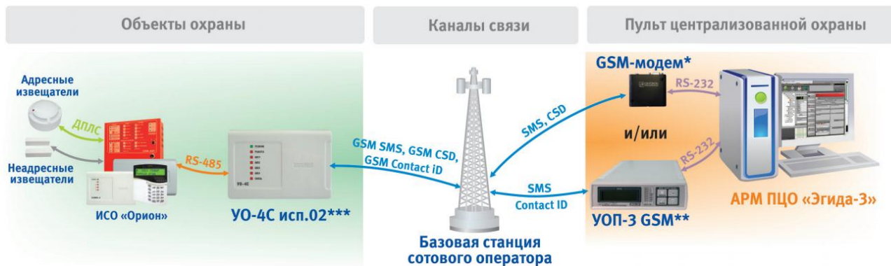
Рис. 2 Схема трансляции извещений от приборов ИСО «Орион» через YO-4C исп. 02 на АРМ ПЦО Эгида-3
