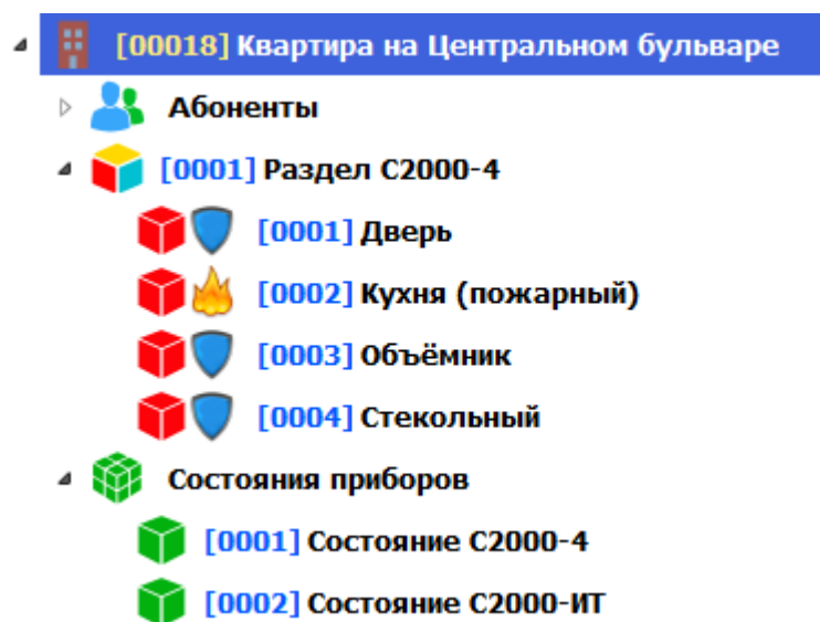
Рис.17 Пример построения логического дерева при работе с С2000-ИТ
