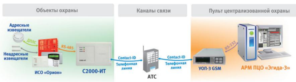
Рис.1 Подключение объектов с приборами ИСО «Орион» по проводной телефонной линии через C2000-ИТ
