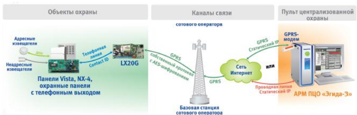
Рис.1 Схема подключения панели NX через согласующее устройство LX20G для передачи по GPRS
