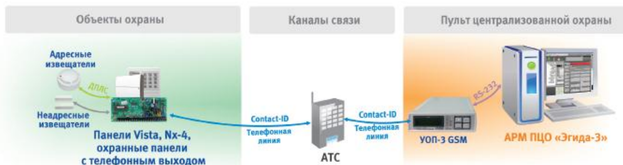
Рис.2 Схема подключение охранных панелей с телефонным коммуникатором через ГТС
