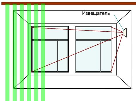
Рис. 4 Установка извещателя между стеклом и занавесками (жалюзи)
