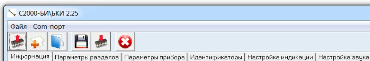
При помощи меню программы **Сom-порт**, можно выбрать com-порт, к которому подключен прибор. В списке com-портов отображаются все com-порты, которые зарегистрированы в Windows.
